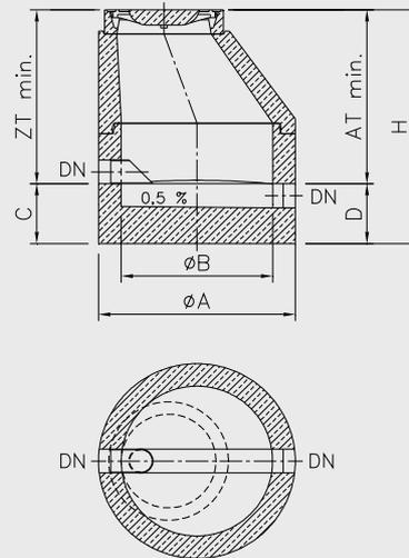
Schnitt- und Grundriss: Schachtaufbau mit Abdeckplatte (PF-AP)
