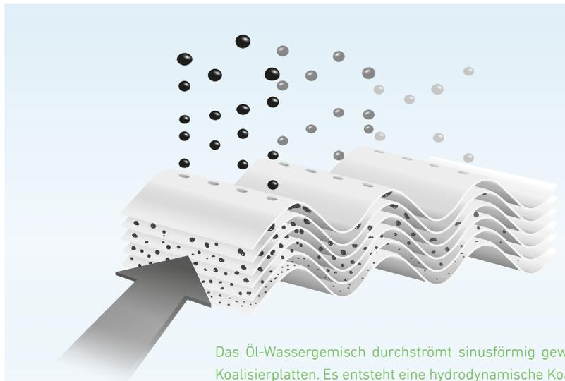
Das Öl-Wassergemisch durchströmt sinusförmig gewellte Koaleszierplatten. Es entsteht eine hydrodynamische Koaleszenz und große Öltröpfen steigen durch die Ölaufstiegsbohrungen Platte für Platte nach oben zur Ölsammelschicht.
