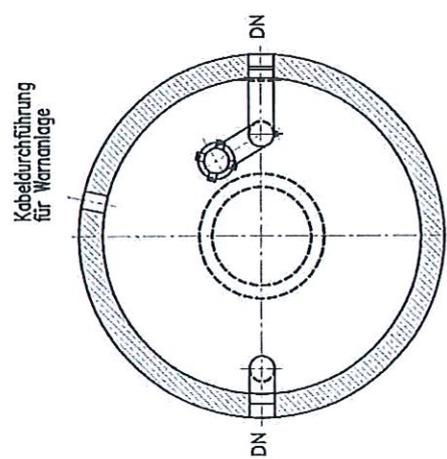
Abscheideranlage für Leichtflüssigkeiten bestehend aus einem vorgeschalteten Abscheider Klasse II und einem integrierten Schlammfang 3A gravis-kompakt
