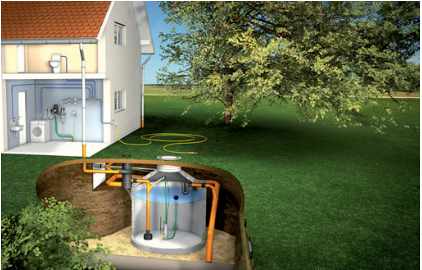
Zisterne mit Regenwassernutzung. Versorgungssicherheit in Zeiten ausbleibenden Niederschlags.
